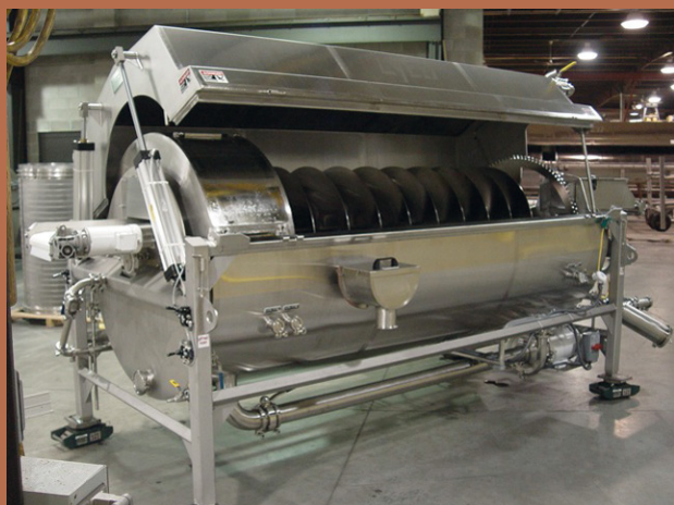
Fig. 1 - Sistema Clean-Flow per la cottura e il raffreddamento del riso.
